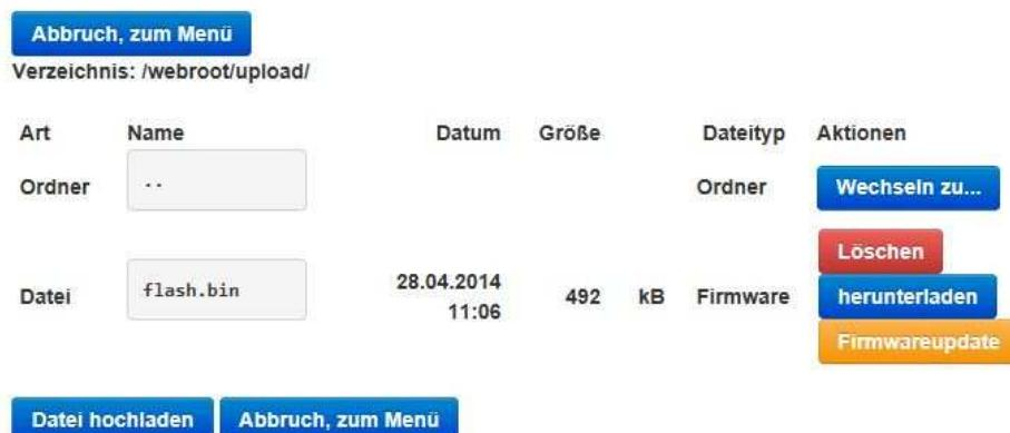
Über die Schaltfläche „**Löschen**“ kann die zur Funkuhr gesendete Firmwaredatei gelöscht werden. Der Löschkvorgang muss noch bestätigt werden. Bei Anwahl der Schaltfläche „**Firmwareupdate**“ gelangt man zu der Updatefunktion.
