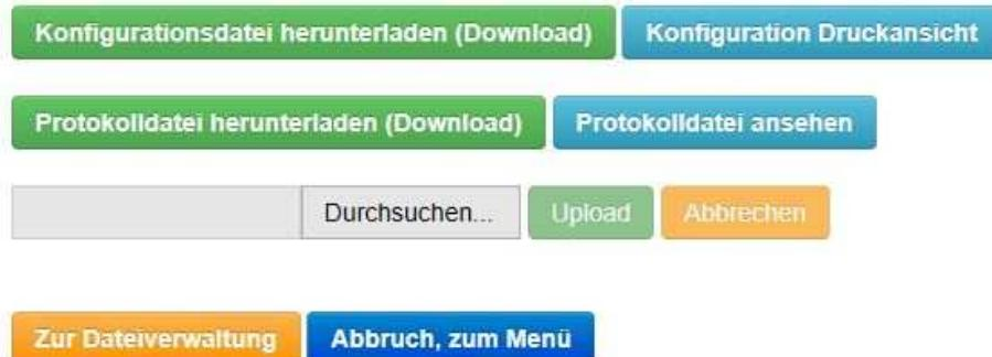
Bei Anwahl der Schaltfläche „Durchsuchen...“ öffnet sich zur Auswahl der Firmwaredatei ein Dialog, der je nach verwendetem Browser unterschiedlich dargestellt wird. Wählen Sie die gewünschte Datei aus und gehen auf „Öffnen“. Der Dateipfad wird jetzt vor der Schaltfläche „Durchsuchen...“ angezeigt. Unterhalb werden zusätzlich noch Dateiinformationen und ein Ladebalken angezeigt.
