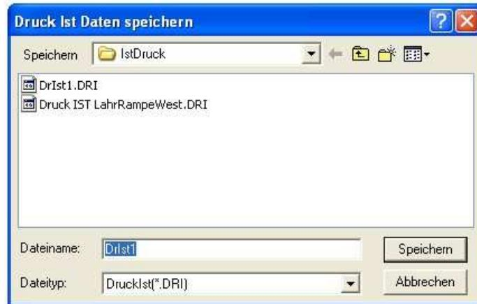
Im Feld **Dateiname** wird dann der gewünschte Name eingegeben unter dem der Ist-Ausdruck abgespeichert werden soll. Mit Bestätigung der Schaltfläche **Speichern** werden die Daten gespeichert.
